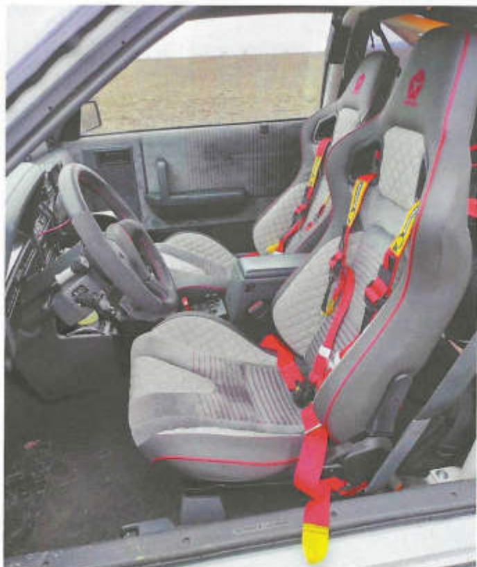
Die mit dem serienmäßigen Sitzbezug der Rücksitzbank und passend dazu abgestimmtem Leder, Keder und Nähten neu eingekleideten Sportsitze sorgen für Seitenhalt und die 4-Punkt-Renngurte mit Zentralverschluss für Sicherheit, wenn mal das Talent ausgeht
